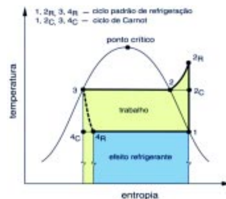
Figura 2: Representação do ciclo padrão de compressão mecânica de vapor em um diagrama temperatura-entropia
